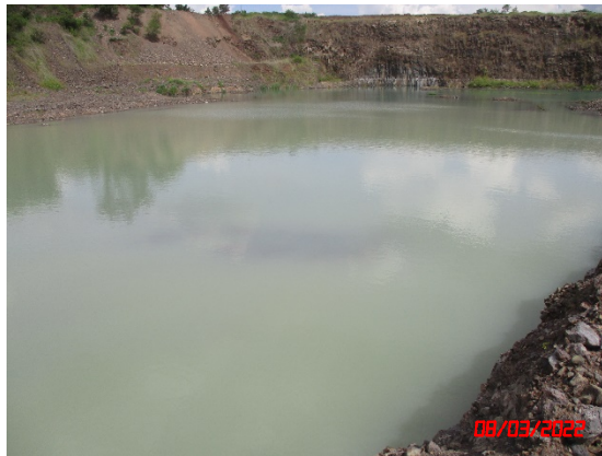
รูปที่ 2-24 บ่อรองรับน้ำบริเวณหน้าเหมืองในจุดต่ำสุด (Sump)
